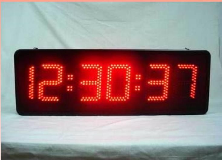
Reloj electrónico de alta calidad formado por un display de 5<sup>1/2</sup> dígitos de alto brillo, el cual presenta la hora en formato de **HORAS : MINUTOS : SEGUNDOS**. Debido a la utilización de unidades luminosas de 5 mm. de diámetro doble fila, y altura de dígitos de 16.5 cms., este reloj ofrece una excelente visión de 80 metros y un amplio ángulo de visión de más de 140 grados.
