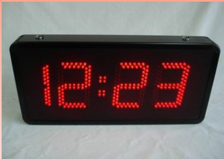
Reloj electrónico de alta calidad formado por un display de 3<sup>1/2</sup> dígitos de alto brillo, el cual presenta la hora en formato de **HORAS : MINUTOS**. Debido a la utilización de unidades luminosas de 5 mm. de diámetro doble fila de LED's, y altura de dígitos de 16.5 cms., este reloj ofrece una excelente visión de 80 metros y un amplio ángulo de visión de mas de 140 grados.
