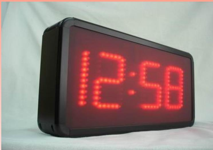
Reloj electrónico de alta calidad formado por un display de 3<sup>1/2</sup> dígitos de alto brillo, el cual presenta la hora en formato de **HORAS : MINUTOS**. Debido a la utilización de unidades luminosas de 5 mm. de diámetro y a la altura de los dígitos de 13.0 cms., este reloj ofrece una excelente visión de 65 metros y un amplio ángulo de visión de más de 140 grados.
