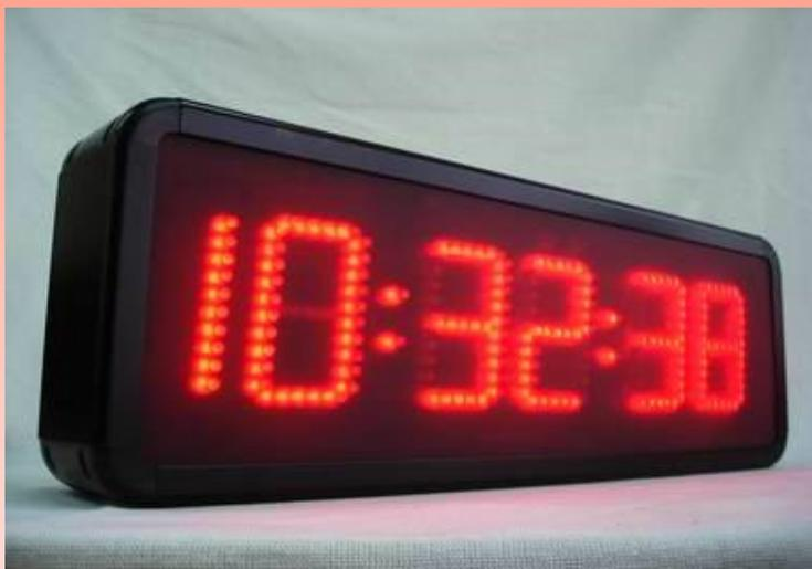
Reloj electrónico de alta calidad formado por un display de 5<sup>1/2</sup> dígitos de alto brillo, el cual presenta la hora en formato de **HORAS : MINUTOS : SEGUNDOS**. Debido a la utilización de unidades luminosas de 5 mm. de diámetro y a la altura de los dígitos de 10.0 cms., este reloj ofrece una excelente visión de 45 metros y un amplio ángulo de visión de mas de 140 grados.
