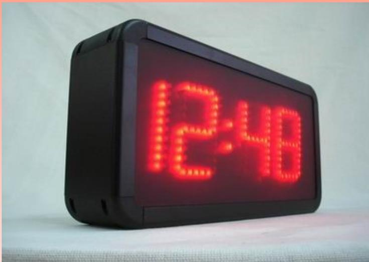
Reloj industrial de alta calidad formado por un display de 3<sup>1/2</sup> dígitos de alto brillo, el cual presenta la hora en formato de **HORAS : MINUTOS**. Debido a la utilización de unidades luminosas de 5 mm. de diámetro y a la altura de los dígitos de 10.0 cms., este reloj ofrece una excelente visión de 45 metros y un amplio ángulo de visión de mas de 140 grados.
