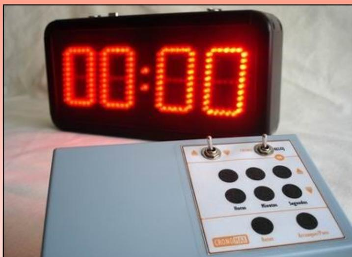
Este equipo tiene la función de ser reloj electrónico y a la vez cronómetro ascendente y descendente. El equipo cuenta con un interruptor que define el modo de operación del equipo como reloj ó cronómetro. En modo cronómetro la hora que tiene el reloj seguirá corriendo normal, independientemente del uso que se le de como cronómetro, al regresar al modo de reloj no habrá que ajustar la hora ya que esta no se pierde y continua actualizada.
